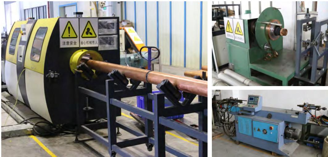
惠程在国内率先自主设计研发出大口径橡塑三层共挤生产设备，实现了屏蔽型管型母线的一体化、连续化、自动化生产，年产能 50000 米以上。生产制造车间占地面积 1800 M<sup>2</sup>，生产材料仓库占地超过 800 M<sup>2</sup>，平均库存量过 1000 万人民币，能满足各类型工程的管母线及时生产与供货。
